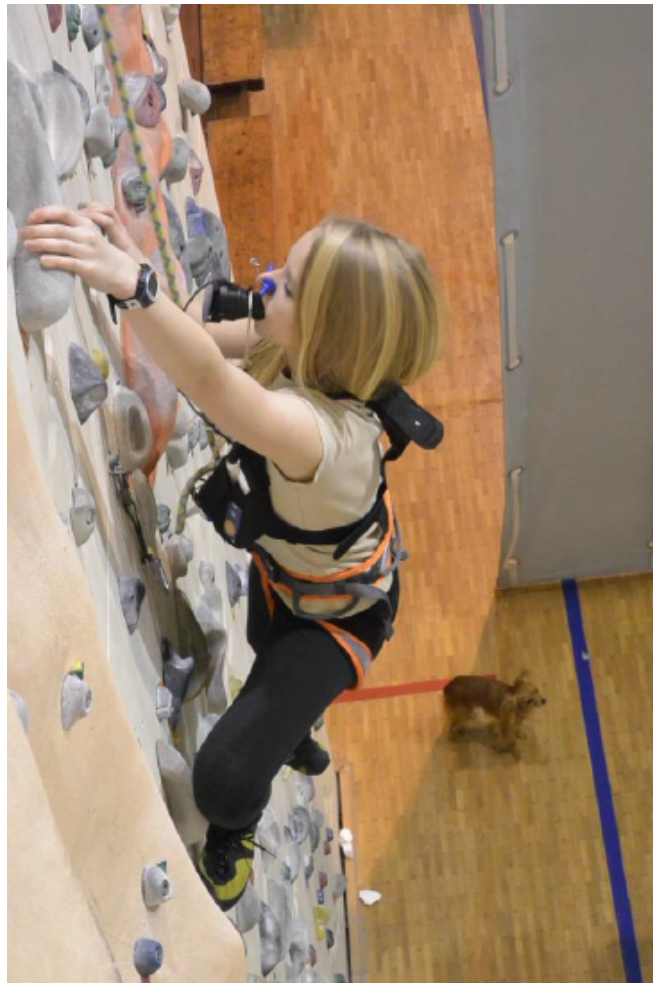
Figure 1. Mesure de la consommation d'oxygène en escalade à l'aide d'un analyseur de gaz portable de type Metamax3B (Cortex, Allemagne). D'après Panackova et al., 2014.
